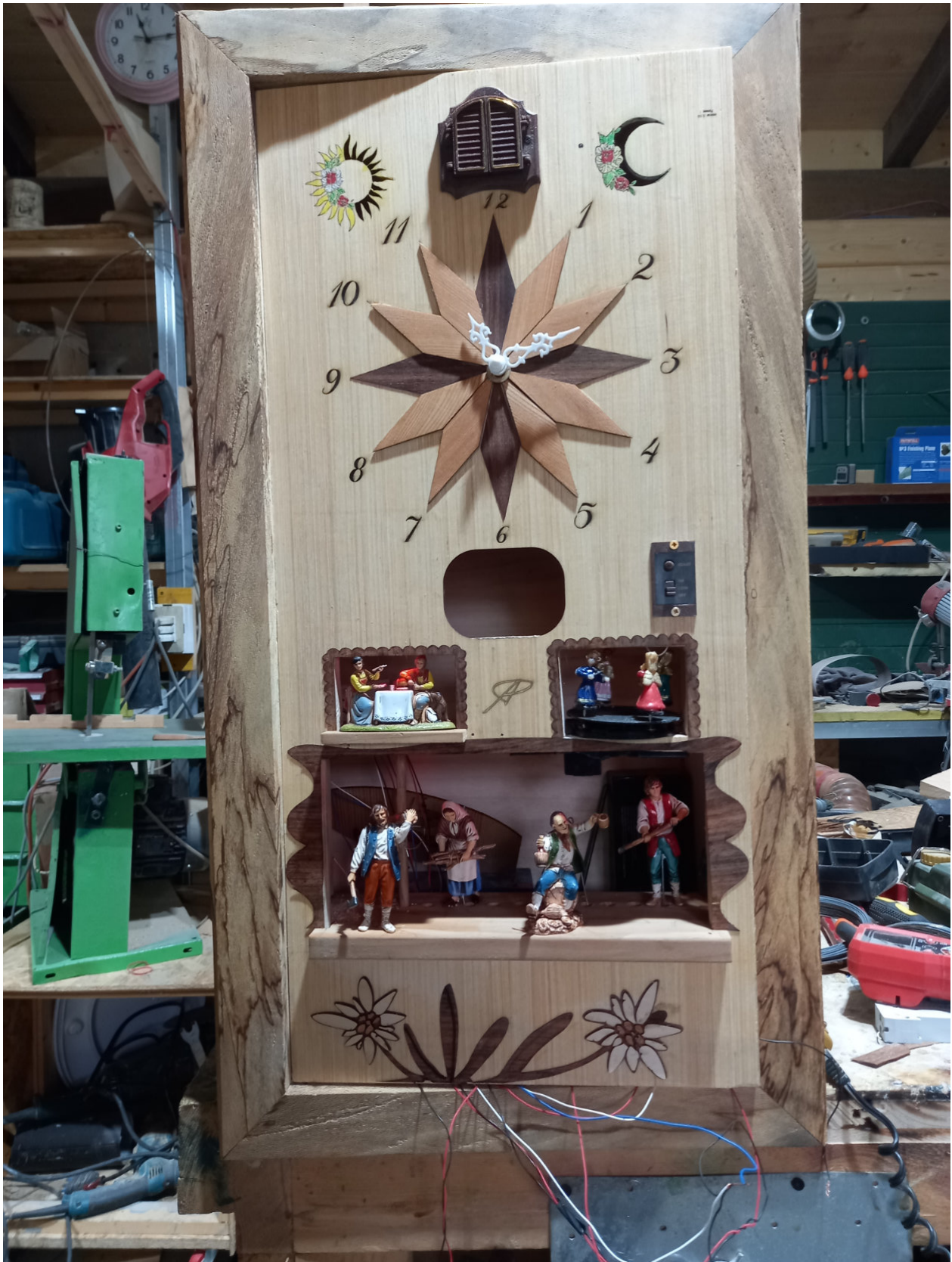
In finitura Orologio cucu con 16 movimenti ogni personaggio movimentato, il tutto con unico motorino che aziona varie cam. opportunamente disposte
